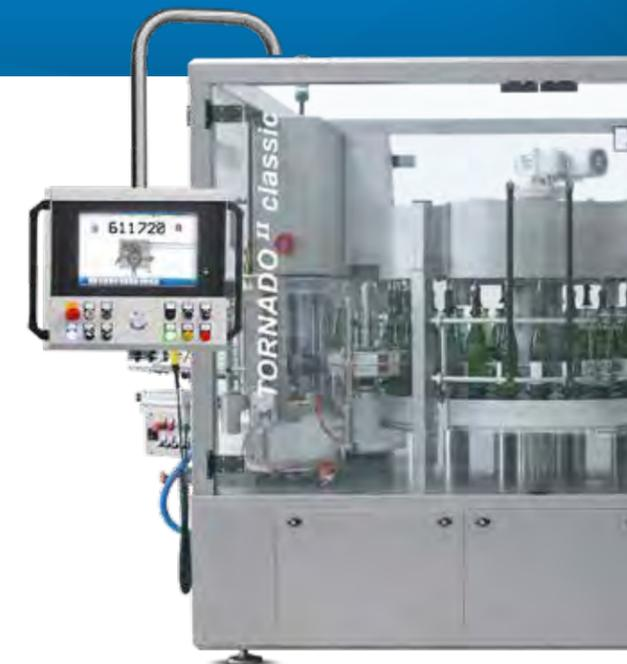
Nassleim-Aggregate nicht elektrisch, sondern mechanisch gekoppelt für den parallelen Einsatz mehrerer Stationen in einer Maschine.
