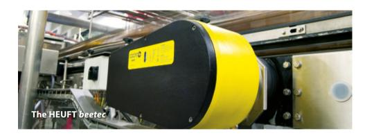
位置和速度、防止能源因摩擦和多余热量而流失时,最大化提升了系统的刚度及精确度. HEUFT beetec 在没有易损件的情况下切实实现了90%的工作效率-较传统驱动器电源消耗减少了30%.
